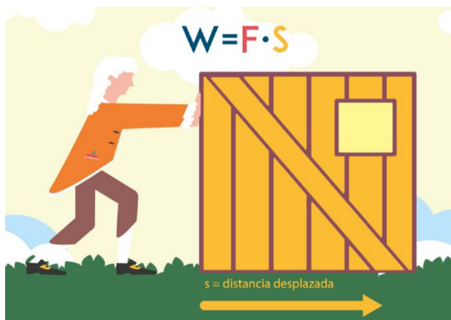
Fig. 4.4. El trabajo (W) se define como el producto de una fuerza (F) por el desplazamiento que genera (S).
